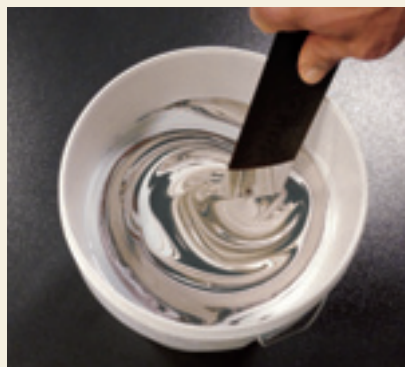
Miscelare bene il prodotto con la nostra spada in plastica Stir well the product using our plastic mixing sword
